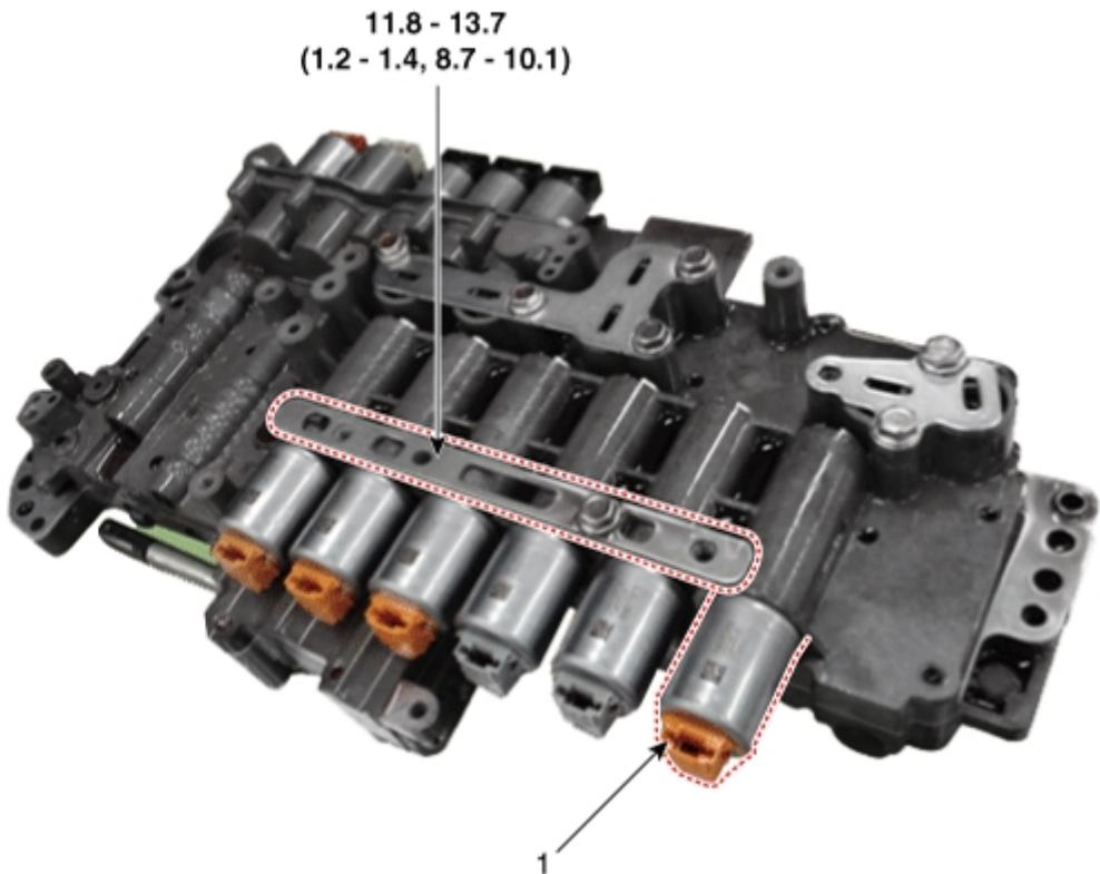
Tightening torque: N·m (kgf·m, lb·ft)
